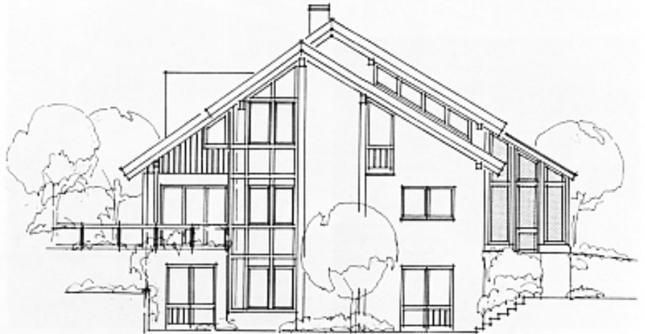
Südfassade des Niedrigenergiehauses in Lörrach mit den charakteristischen Luftkollektoren zur hybriden Sonnenenergienutzung.
